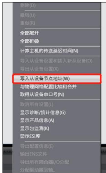
在弹出的界面中，在设置值下写入要分配的节点地址，设置的节点地址要与网络组态的节点地址相一致，否则不会建立通讯连接：
