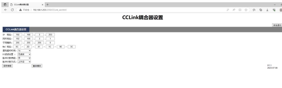
**IP 地址：**设置耦合器与所连接的控制器通讯用，需要与控制器的 IP 地址在同一网段中。
