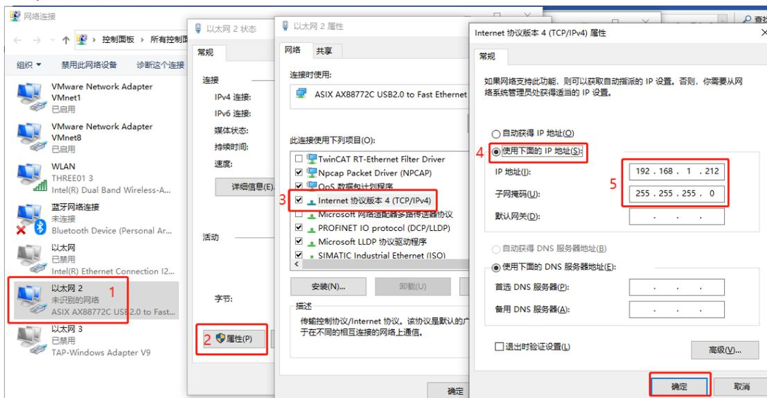
设置完电脑本地 IP 后，将 DFH20-CLI-DI16P/N-DO16N-V1 模块与电脑通过网线连接，打开浏览器 (IE 浏览器或者 360 浏览器都可以)，在地址栏中输入 192.168.1.253，然后回车进入到 DFH20-CLI-DI16P/N-DO16N-V1 的网页参数设置页面，如下图所示：
