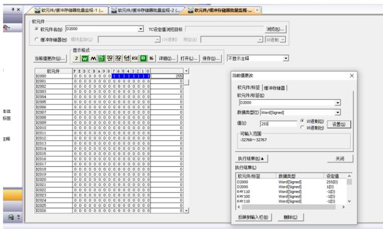
使用 smart200 以 1K 的频率发送 20K 个脉冲，实际接线接入第 1 通道，计数器 1 的地址为 D1016~D1017，如图所示记录的脉冲数：
