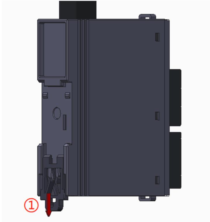
② 将上端卡扣位置安装到导轨，然后将模块下侧放置在导轨上，最后将卡扣往上卡紧，即可完成安装
