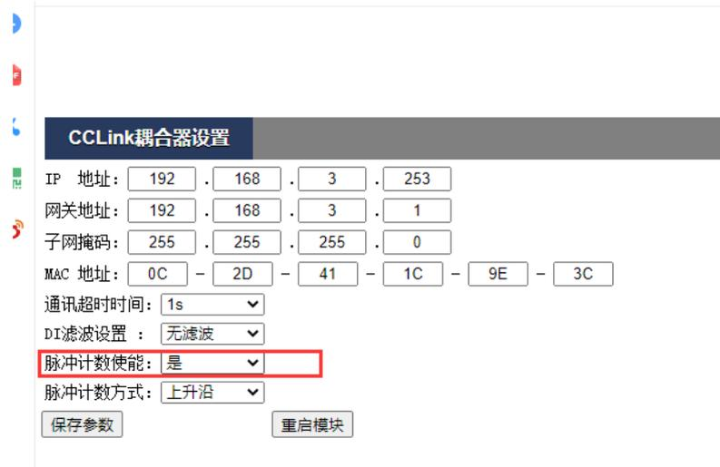
在 GX works 软件地址 D2000 低 8 位的 bit0~bit7 设置为 1，输入通道脉冲计数通道。
