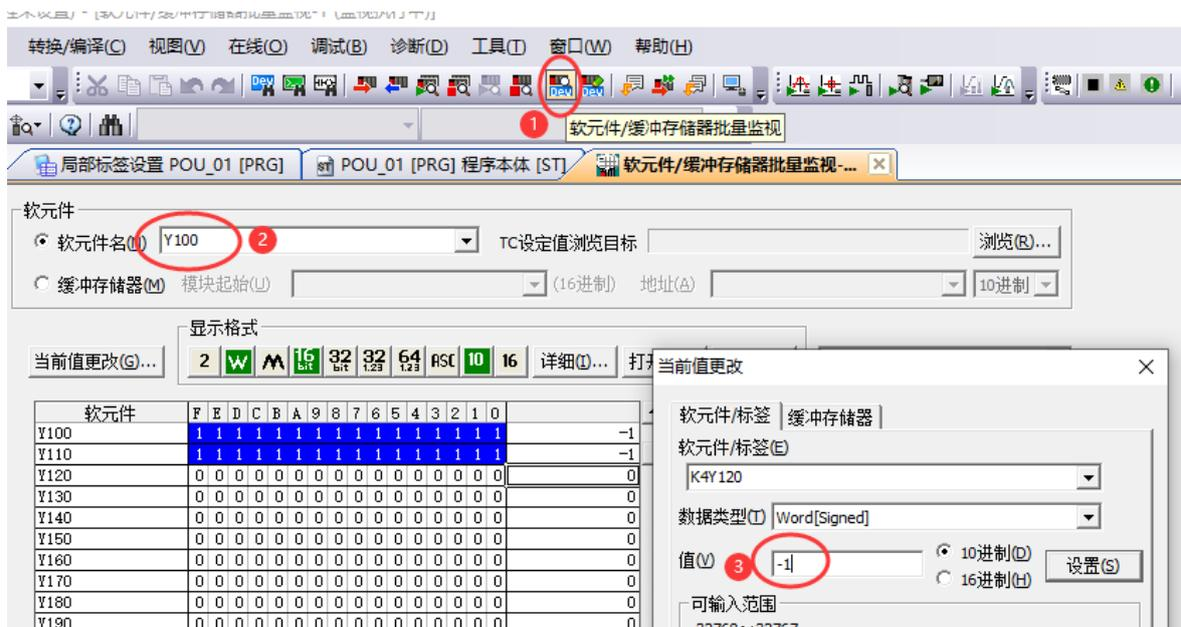
选择【软元件/缓冲存储器批量监视】，在【软件元名】输入对应的输出地址（本示例 X100），可以查看模块输入状态。
