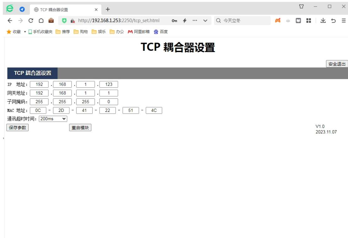
**IP 地址:** 设置模块与所连接的控制器通讯用, 需要与控制器的 IP 地址在同一网段中, 192.168.1.253 (默认)
