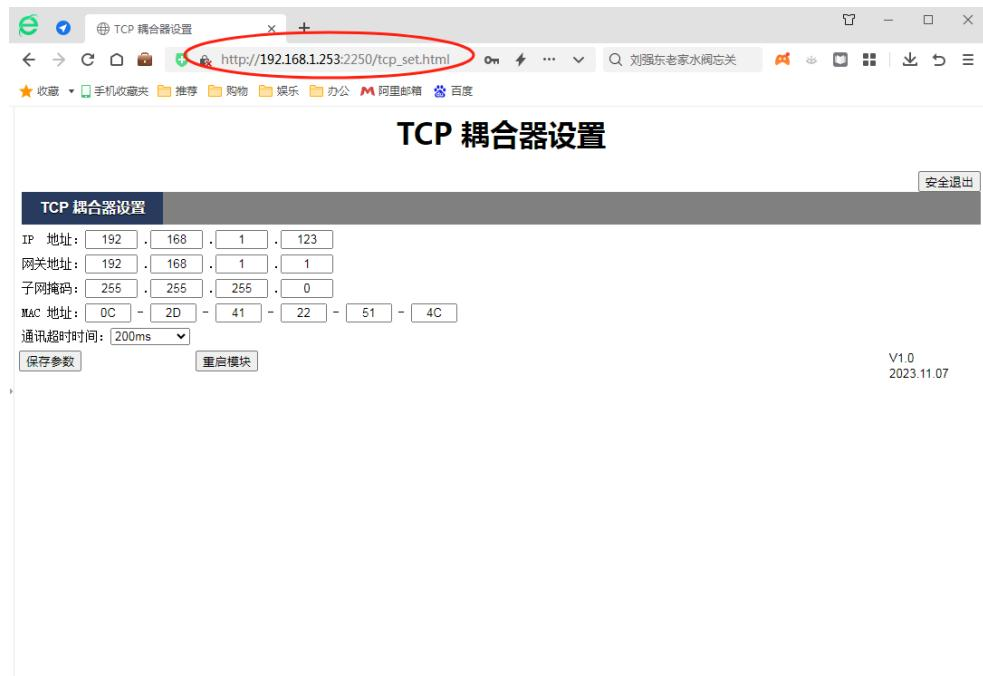
可以在 DFHB20-MT-DI16P/N-DO16P-V1 的网页参数配置页面配置模块的 IP 地址等相关参数。
